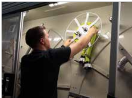
Gerätewart Justin Hiller bedient die Schlauchwaschanlage.
