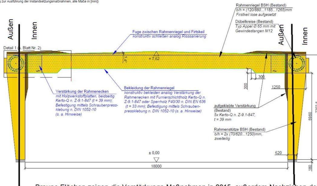
Braune Flächen zeigen die Verstärkungs-Maßnahmen in 2015, außerdem Nachziehen der Dübelkreise in diesem Bereich und Rissverpressungen
