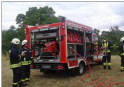
Die Besetzung des Tragspritzenfahrzeuges mit Wasser umfasst sechs Mann, angeleitet vom Staffelführer. 750 Liter Wasser führen die Kameraden im Tank auf dem Fahrzeug mit, die Pumpe kann bis zu 1000 Liter/
